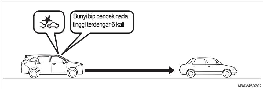
Saat sistem menentukan risiko tabrakan dengan kendaraan di depan, ini akan memberi tahu pengemudi dengan buzzer dan indikator tampilan (→H. 253) untuk mengambil tindakan mengelak untuk menghindari tabrakan.
